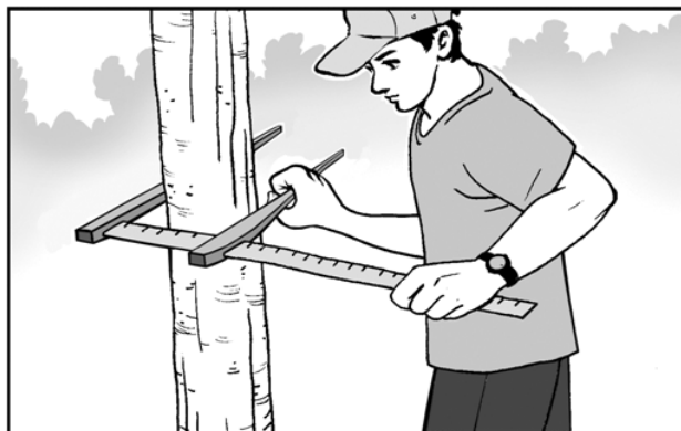
Figura 18. Ilustração de medição de diâmetro à altura do peito utilizando suta em um indivíduo de pequeno grossor
