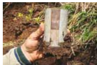
Preparação para extrair a amostra de solo sem destruir o material
