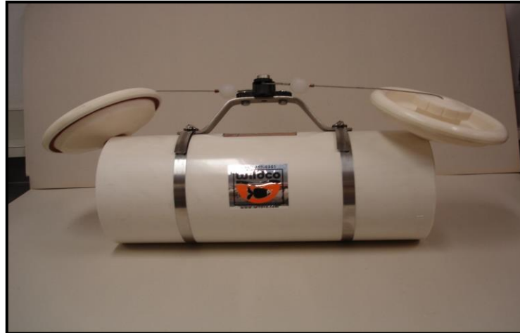
Figura 1.8– Garrafa de Van Dorn de descida horizontal.
