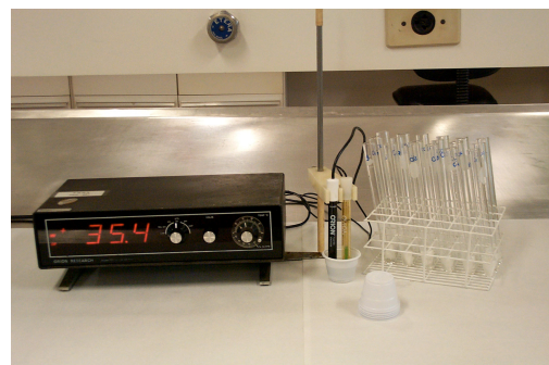
Figura 18. Análise potenciométrica dos extratos.
