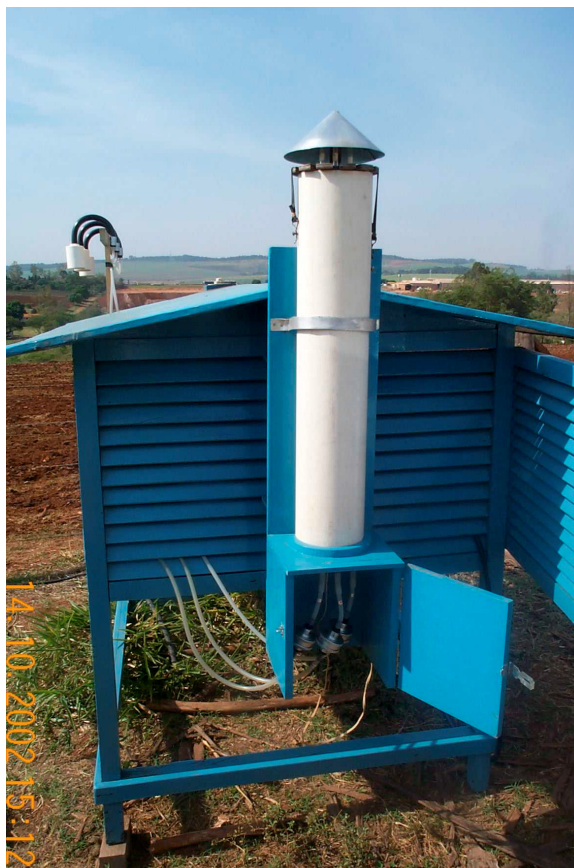
Figura 26. Vista dos amostradores de tubo de difusão (as varetas de vidro estão internas à proteção e na parte inferior estão os filtros de fluoreto particulado).
