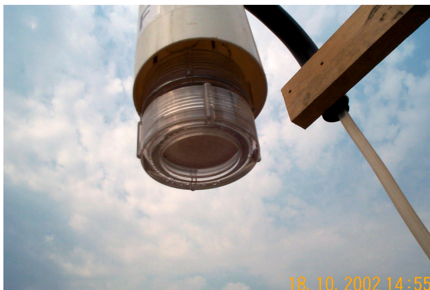
Figura 24. Vista do amostrador de fita duplo interno à proteção de PVC
