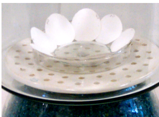
Figura 7. Secagem dos discos impregnados em dessecador.
