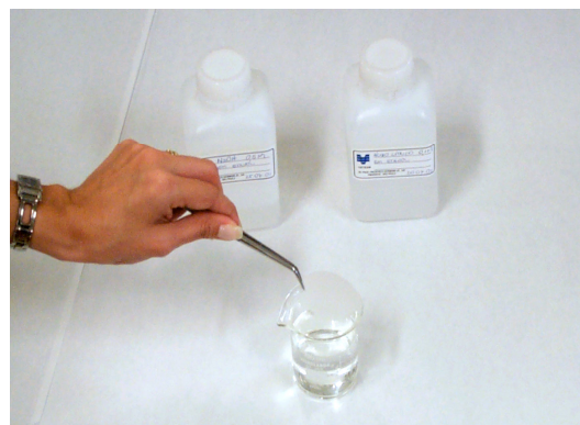
Figura 6. Impregnação dos discos com soluções ácida e básica.
