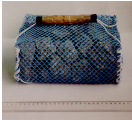
Figura 1. Substrato artificial do tipo cesto retangular preenchido com pedras do de brita.
