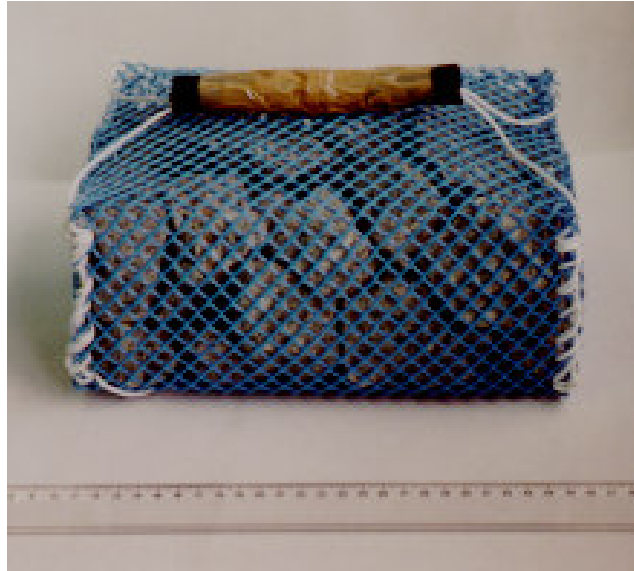
FIGURA 1. Substrato artificial do tipo cesto preenchido com pedra de brita.
