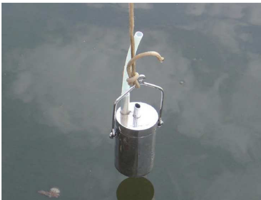
Figura 18 – Coleta de amostra de água com auxílio de batiscafo de aço inox
