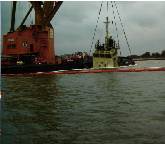
Figura 32 – Rebocador Pegasus sendo içado dentro de cerco de proteção contra vazamento de óleo Fonte: CETESB
