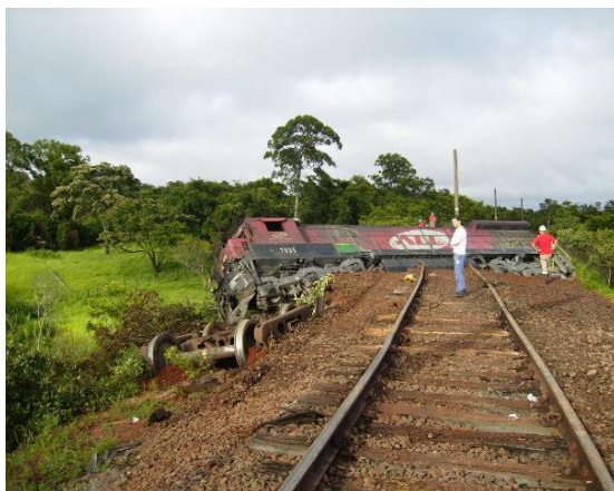
Figura 48 - Vagões-tanques descarrilados contendo gasolina Fonte: CETESB
