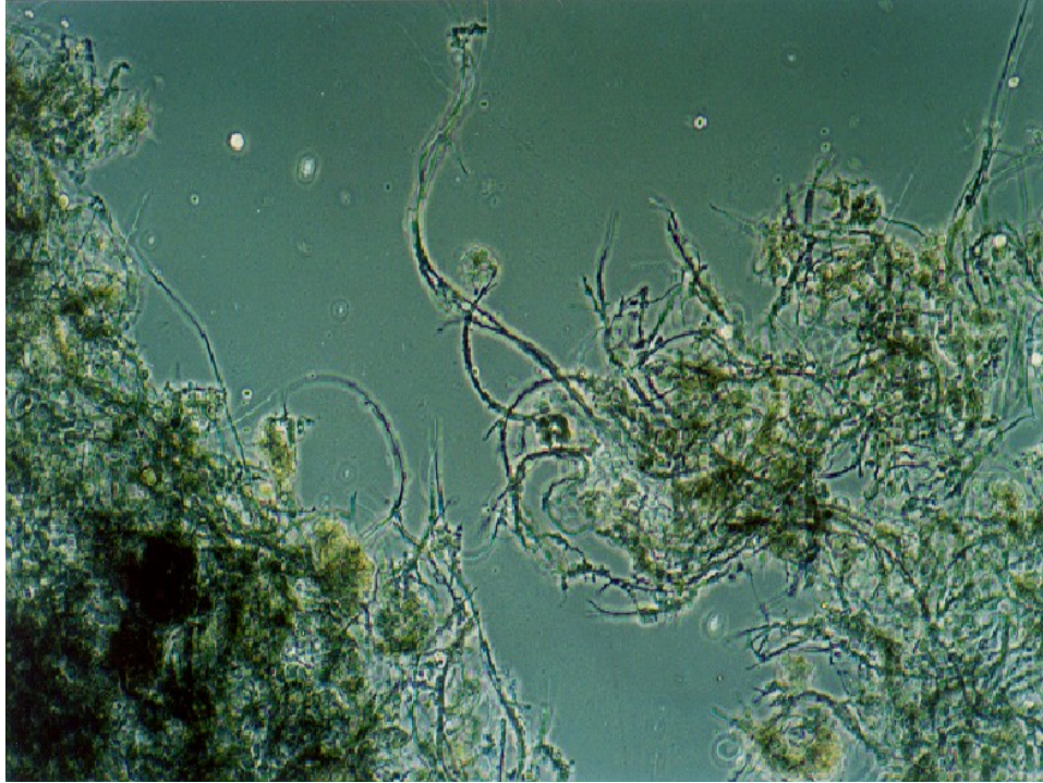
Figura 25 - Crescimento excessivo das bactérias filamentosas no tanque de aeração, observadas em microscópio com aumento de 1000 X.
