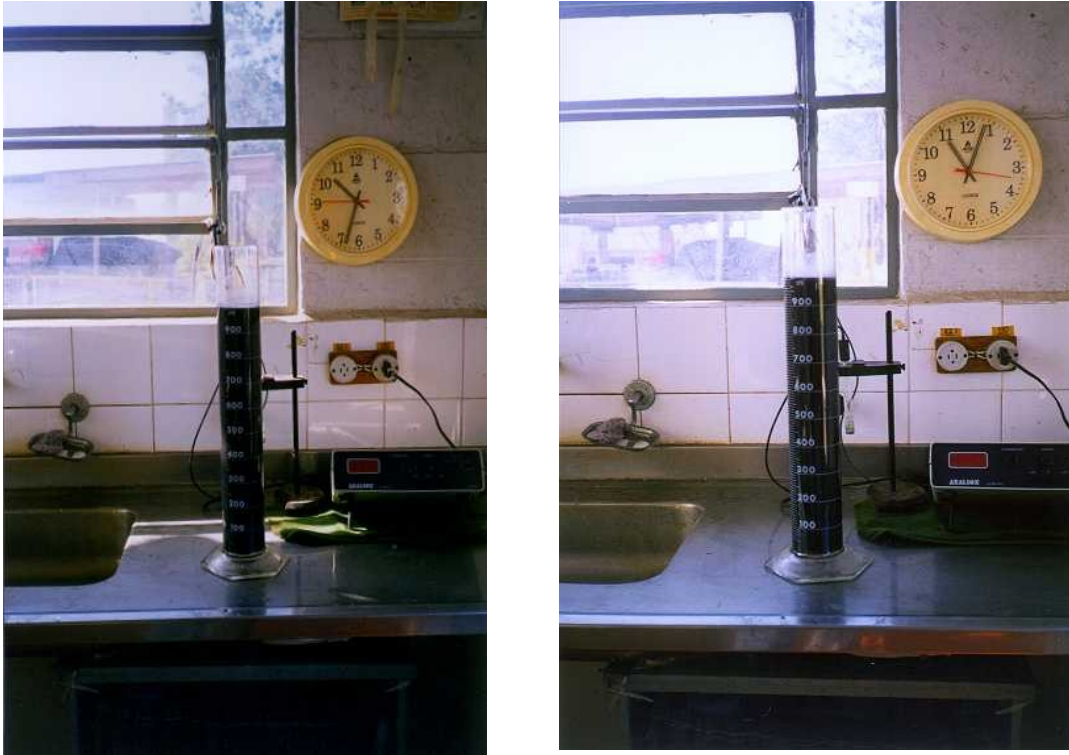
Figura 21 - Teste de IVL mostrando a dificuldade da separação das fases após 30 minutos de sedimentação, característica de processo de tratamento deficiente.
