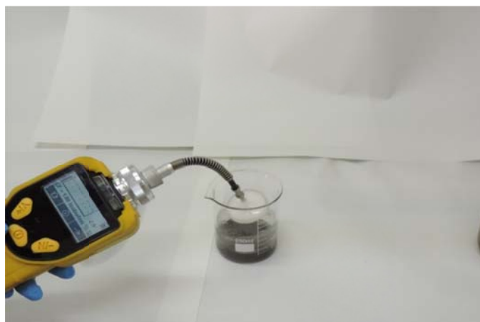
FIGURA 69 – Avaliação da concentração de gases e vapores sobre a amostra úmida. Fonte: CETESB (Banco de Imagem).
