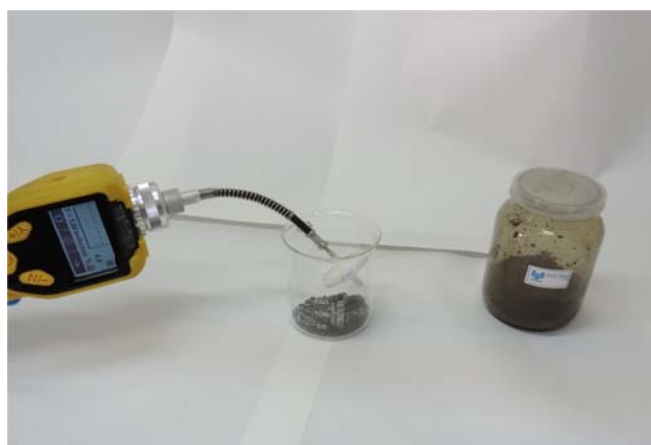
FIGURA 67 – Avaliação da concentração de gases e vapores sobre a amostra seca. Fonte: CETESB - Companhia Ambiental do Estado de São Paulo (Banco de Imagem)
