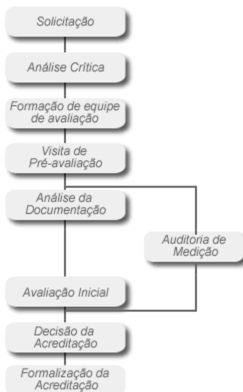
Figura 3 - Fluxograma básico do processo de acreditação de laboratórios de ensaios e calibração (Fonte: INMETRO, 2006b; INMETRO, 2009).
