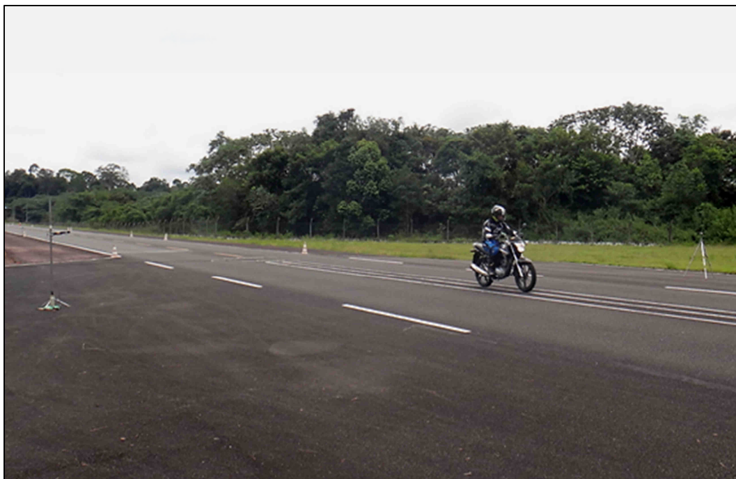
Figura 10 – Ensaio de ruído de passagem
