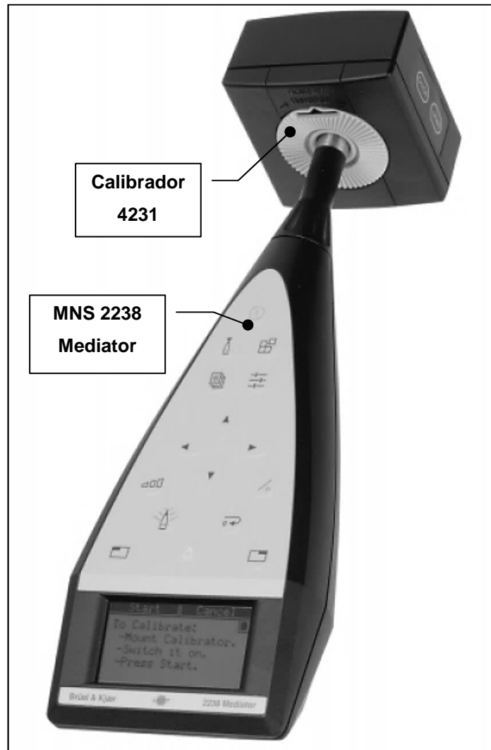
Figura 34 – MNS Brüel & Kjaer 2238 Mediator com Calibrador 4231 montado no microfone
