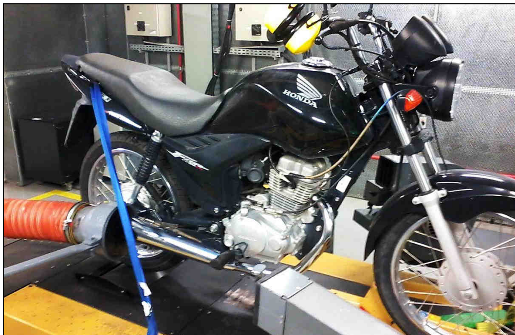
Figura 36 – Dinamômetro para medição de potência – motocicleta com escapamento do tipo “estralador”
