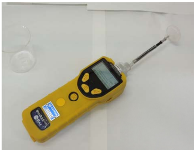
FIGURA 16 – Registro fotográfico do fotoionizador portátil utilizado para determinação de amônia anidra.
