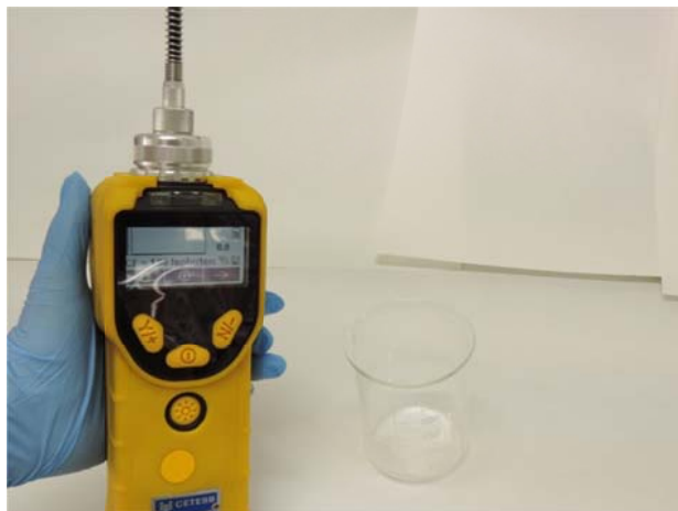
FIGURA 66 – Avaliação da concentração de gases e vapores no interior da capela do Laboratório de Química Inorgânica da CETESB, antes do início do teste. Fonte: CETESB - Companhia Ambiental do Estado de São Paulo (Banco de Imagem)
