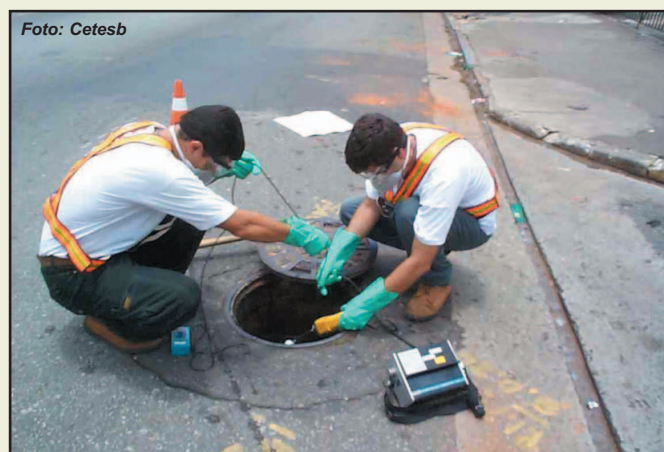
Monitoramento de vapores inflamáveis em rede subterrâneas por técnicos da Cetesb
