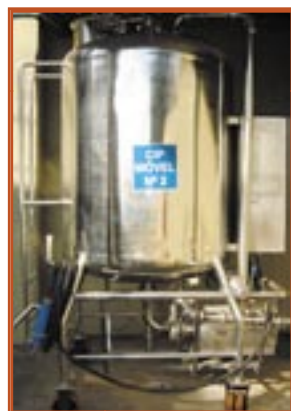
EQUIPAMENTO DE CIP MÓVEL PARA SANITIZAÇÃO DE EQUIPAMENTOS
