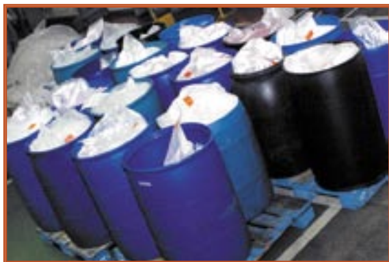
ARMAZENAGEM DE SOBRAS DE MATERIAL RECUPERADO NAS OPERAÇÕES DE LIMPEZA, PARA REINCORPORAÇÃO EM BATELADAS POSTERIORES
