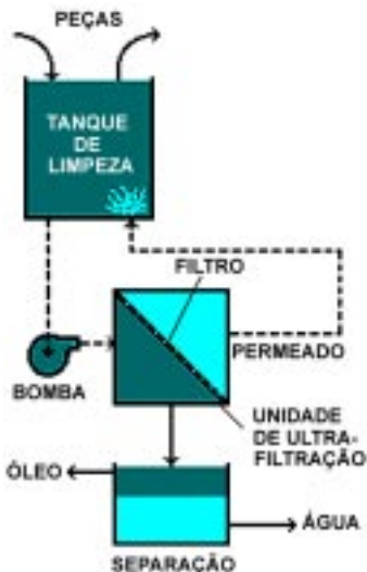
Figura 16: Sistema de Ultrafiltração [8]
